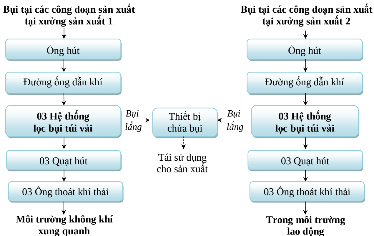
Hình 3.5. Sơ đồ công nghệ hệ thống thu gom, xử lý bụi của cơ sở.
